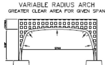
NOTE: ALL RADI INFINITELY VARIABLE FOR ARBITRARY ARCH GEOMETRY
